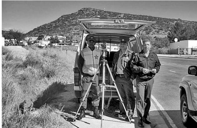
de registro y, preferentemente, el mismo operador del equipo. Si es posible, el equipo de registro, tal como un radar, debe estar oculto, ya que los usuarios de la vía pública pueden detectar el equipo y cambiar la velocidad, o incluso frenar por miedo a ser multados.
